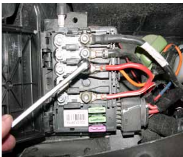
2. Lossa kabeln. Den får inte komma i kontakt med omgivande kablar! Återställ kabel och skyddskåpa efter programmeringen.
